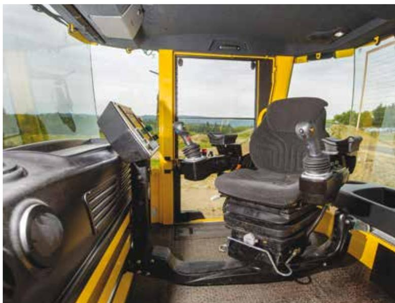
5. L'operatore può lavorare in una posizione comoda ed ergonomica con il sedile che può ruotare anche di 270°
